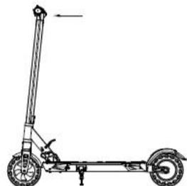
4. Убедитесь, что фиксатор зашел в паз и надежно зафиксирован
