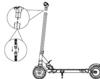
4. Вставьте рулевую головку в стойку. Закрутите болты, используя инструмент. Включите питание.
